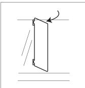
STEP 4. SLIP THE POCKET ASSEMBLY OVER THE PRESET SCREWS.
